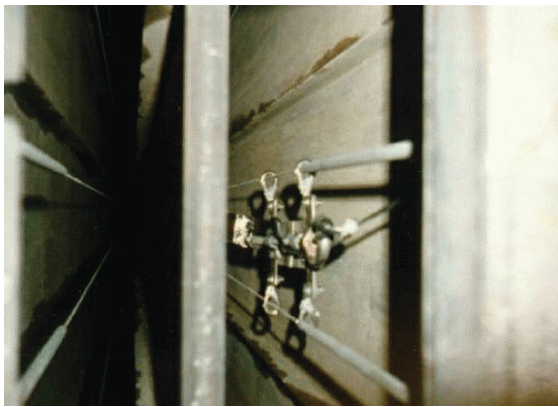
Şekil 5. Ağırlıklandırılmış Telli ESP'lerde Kanatçıklı Anemometre Kurulumu
