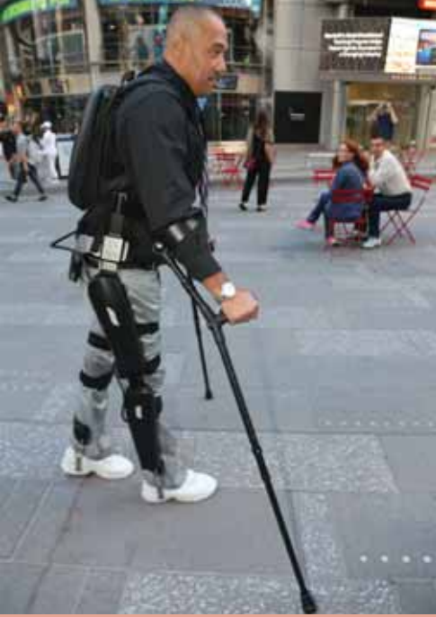
ReWalk ideal olarak düz ve pürüzsüz araziye uygun ve bu tür yüzeyler alıştırmaya yapmak için en iyisi
