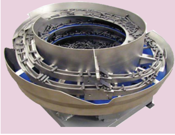
Şekil 9. (T) Şeklinde Parça Besleyen Vibratörde Kazan Dışına Taşınmış Rampalar
