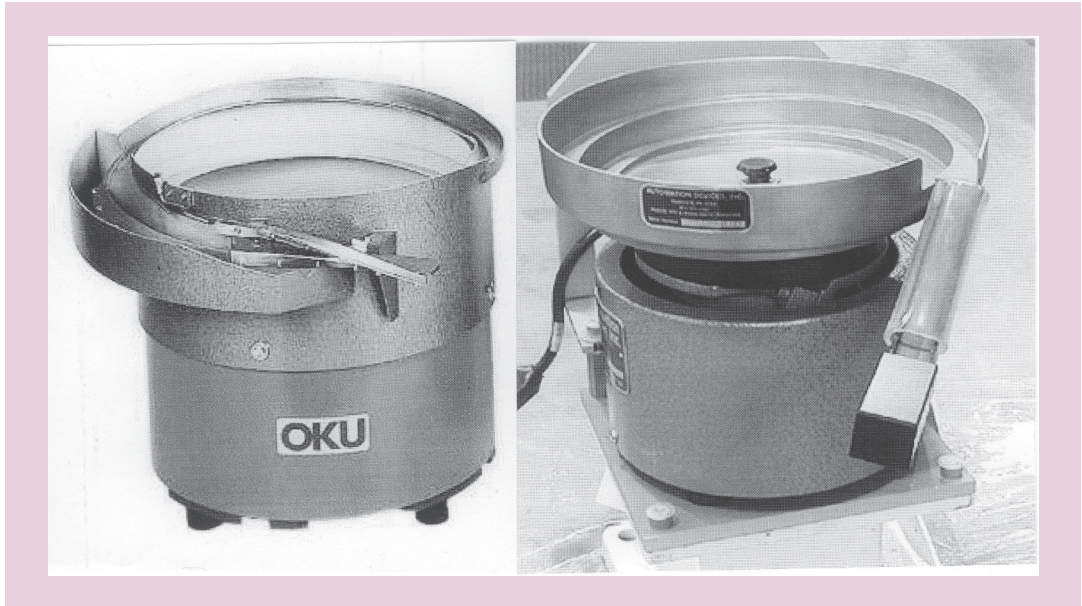
Şekil 8. Silindirik ve Kademeli Kazanlı Vibratörler
