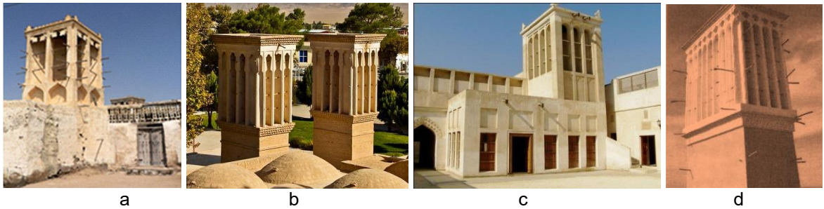
Şekil 23. Dört yönlü kare (a,b) [115,169] ve dikdörtgen (c,d) [161, 162] kesitli yelgel uygulamaları.
